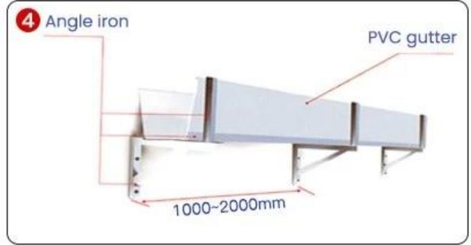
1. Yağmur oluğunu monte ederken, alt destek çerçevesi çelik çerçeveden yapılmalı ve malzeme yeterince sağlam olmalıdır. Alt çerçeve düz bir çizgide olmalı ve 1,5-1,8 metrede bir destek yeri bulunmalıdır. Yağmur oluğunun iki tarafı demir çerçevelerle korunmalıdır.
