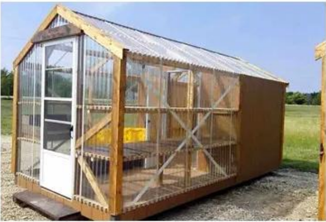
FRP 是 一種 輕 便 且 堅 固 的 材 料 ， 可 用 於 建 造 溫 室 的 屋 頂 和 側 壁 。 它 具 有 優 越 的 耐 用 性 和 抗 腐 蝕 性 ， 能 有 效 保 護 內 部 植 物 免 受 天 氣 變 化 的 影 響 。 此 溫 室 採 用 木 質 框 架 和 FRP 材 料 製 成 ， 既 美 觀 又 實 用 。
