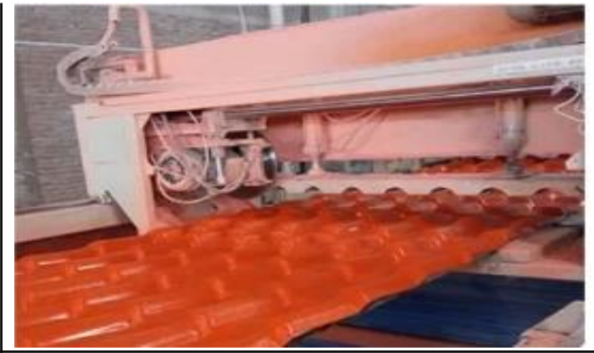
3. 正在被加工成片的ASA原料
