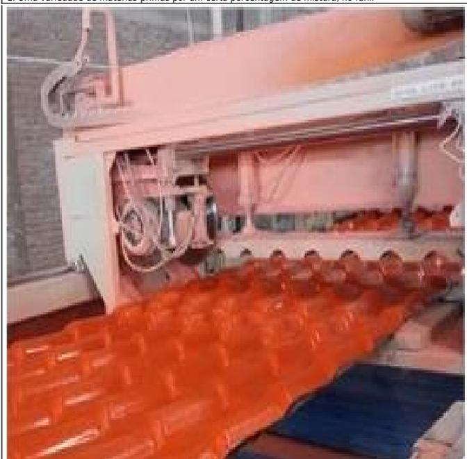
3. Em seguida, através da pressão do molde, aperte a moldagem, resfrio, através da máquina de tração introduzida lentamente
