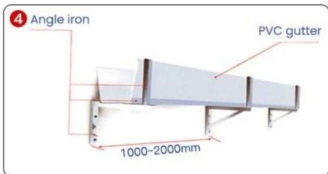
1. Ao instalar a calha de chuva, a estrutura de suporte inferior deve ser feita de estrutura de aço e o material deve ser suficientemente forte. A estrutura inferior deve estar em linha reta e deve haver um local de apoio a cada 1,5-1,8 metros. Os dois lados da calha de chuva devem ser protegidos por armações de ferro.
