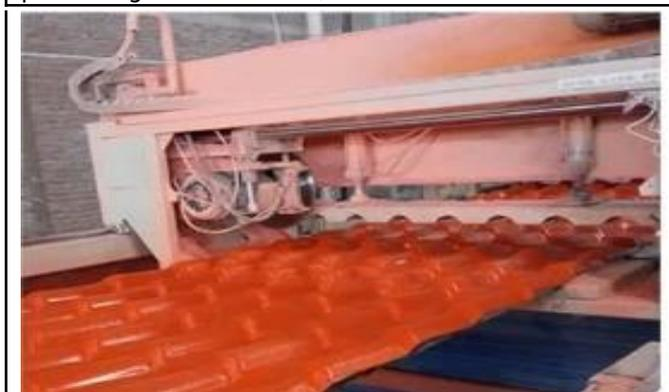
3. Em seguida, através da pressão do molde, lasque a moldagem, esfrie, através da máquina de tração introduzida lentamente
