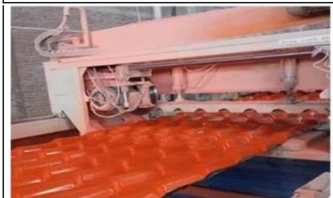
3. לאחר מכן דרך לחץ העובש, הכנס את היציקה, הקירור, דרך מכונת המתיחה לאט לאט
