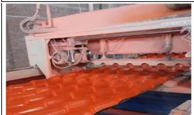
3. לאחר מכן, דרך לחץ העובש, הכנס לאט את הדפוס, הקירור, דרך מכונת המתיחה
