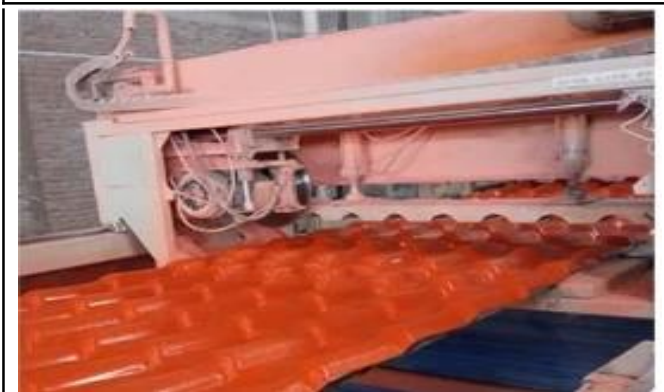
3. לאחר מכן, דרך לחץ העובש, הכנס לאט את הדפוס, הקירור, דרך מכונת המתיחה
