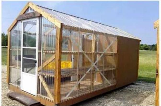
Le piastrelle in FRP hanno una buona trasmissione della luce e sono generalmente adatte per applicazioni in ville di resort turistici, coperture di aziende agricole e così via.
