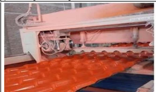
3. Ensuite, à travers la pression du moule, le moulage élastique, le refroidissement, à travers la machine de traction lentement introduite
