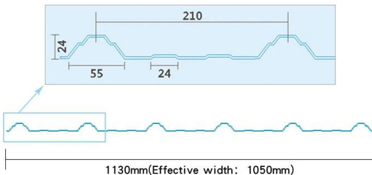
Le produit est une dalle composite anti-corrosion bicolore à trois ou trois couleurs à trois couches super résistante aux intempéries, et le matériau de la couche de surface est une résine d'ingénierie ASA super résistante aux intempéries. Au milieu se trouve une résine de vinyle poly-enregistrée avec une excellente ténacité. Le matériau du fond est un matériau blanc résistant à l'usure pour augmenter la sensation d'espace, la luminosité et la résistance à l'usure de la plante.
