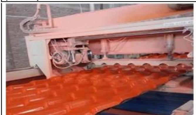
3. Luego, a través de la presión del molde, se aplica plástico al moldeado, se enfría y se introduce lentamente a través de la máquina de tracción.
