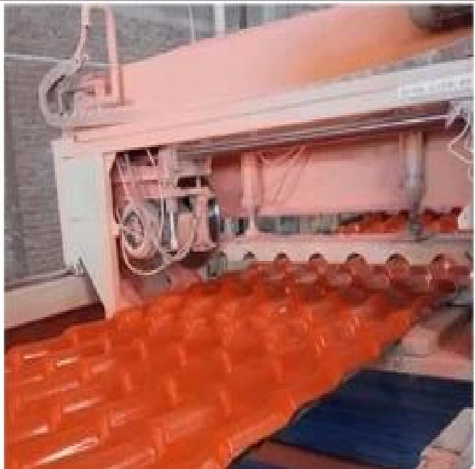
3. Luego, a través de la presión del molde, se aplica plástico al moldeado, se enfría y se introduce lentamente a través de la máquina de tracción.
