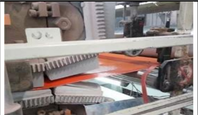
2. 橙色的屋頂瓦片，由聚碳酸酯製成，具有優異的耐用性和抗紫外線性能。
